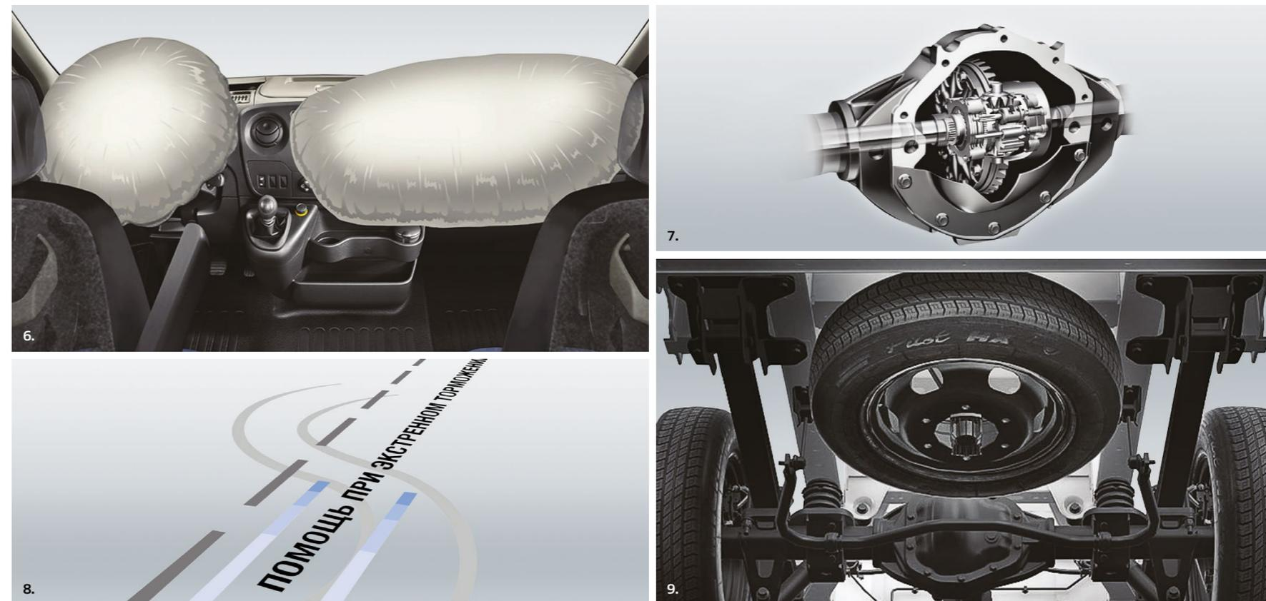
**6. Подушка безопасности** водителя и пассажиров (опция). **7. Для заднеприводных версий** доступна автоматическая блокировка дифференциала, что повысит мобильность на участках с плохим дорожным покрытием. **8. ABS** – система электронного распределения тормозных усилий, а также система экстренного торможения (EBD). **9. Полноразмерное запасное колесо**, компактно расположенное под грузовым отделением, поможет быстро вернуться на маршрут в случае прокола шины.
