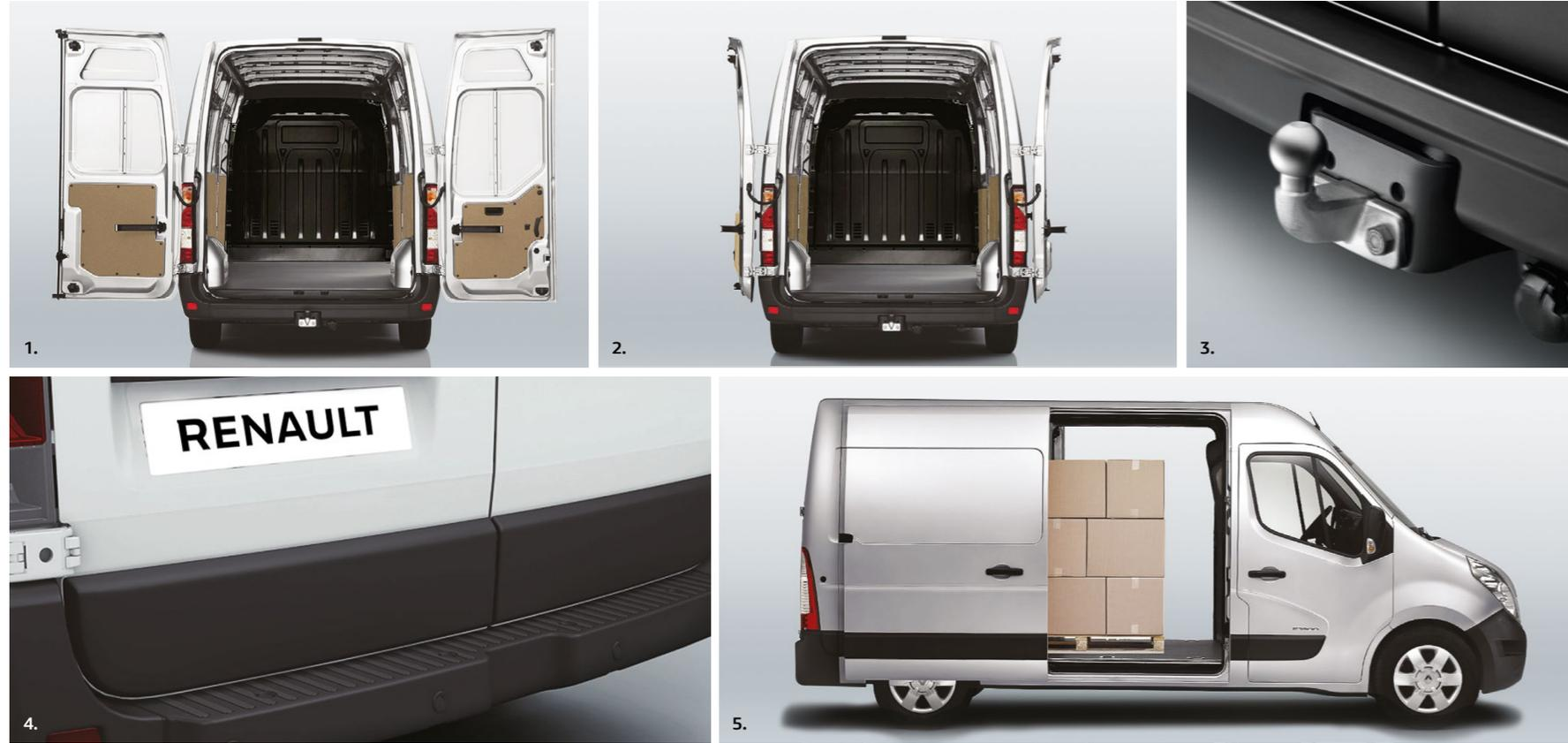
**1-2.** Для задних дверей с фиксаторами можно выбрать угол открытия 180 или 270°. **3.** Сцепное устройство позволяет буксировать прицепы массой до 3 тонн. **4.** Для заднеприводных версий по умолчанию предусмотрен бампер со ступенькой. **5.** Для осуществления сквозной погрузки и разгрузки можно заказать вторую боковую дверь со стороны водителя.
